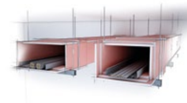
Kabelkanäle 4-seitig Brandschutz bis 90 Minuten Feuer- widerstand
