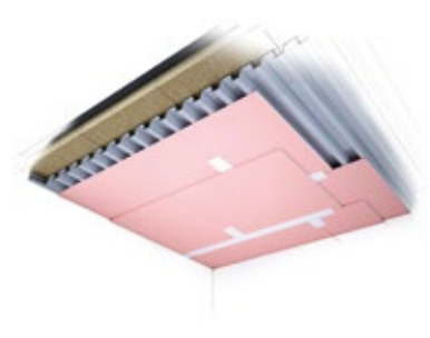
Bekleidung von Trapezblechdächern Brandschutz bis 90 Minuten Feuerwiderstand
