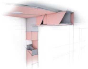
Stahlstützen- & Stahlträgerbeklei- dungen 3-seitig / Brandschutz bis 180 Minuten Feuerwiderstand
