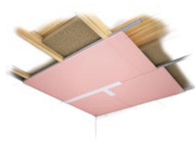
Bekleidung von Holzbalkendecken Brandschutz bis 90 Minuten Feuerwiderstand
